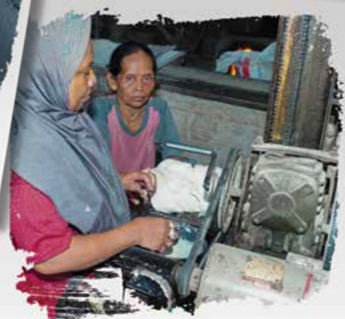
3 Adonan padat selanjutnya masuk tahap pencetakan kerupuk hingga berbentuk lembaran.
