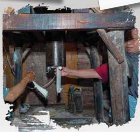
3 Adonan padat selanjutnya masuk tahap pencetakan kerupuk hingga berbentuk lembaran.
